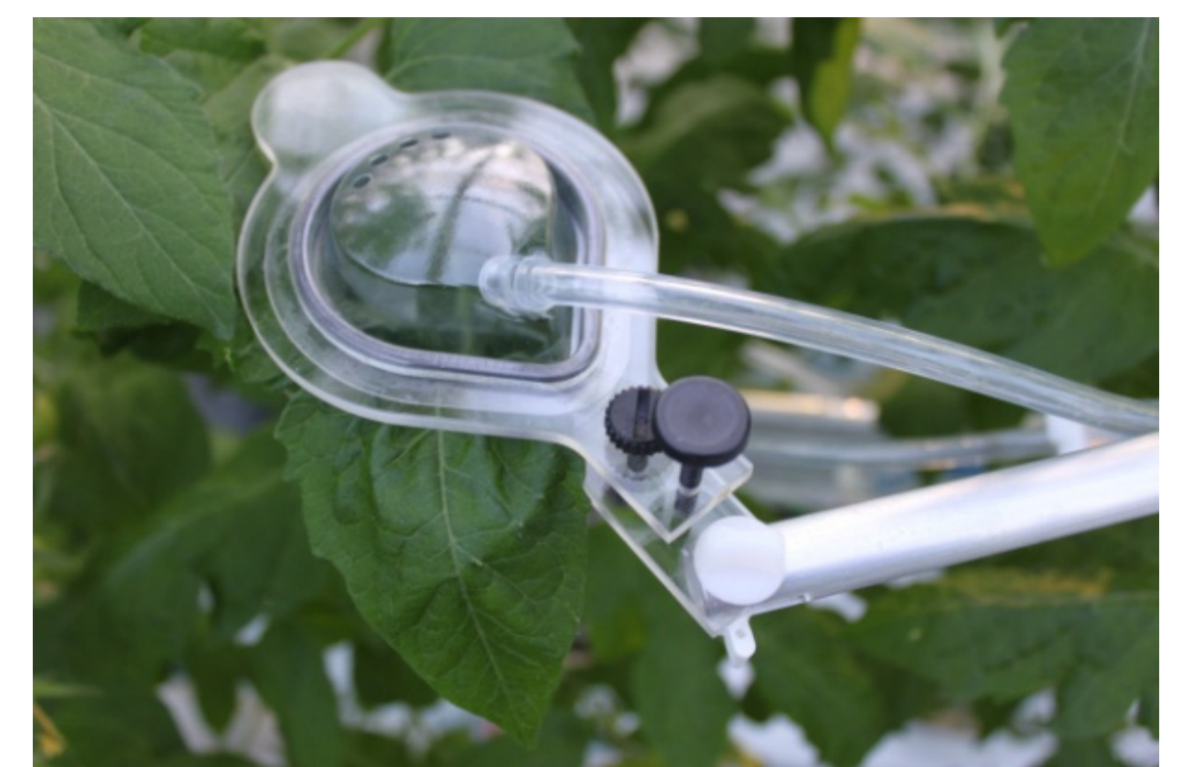
Blattkuvette des Berliner Pflanzenmonitoring-Systems (Bermonis) zur Messung der Photosynthese, Transpiration und Bestandstemperatur
